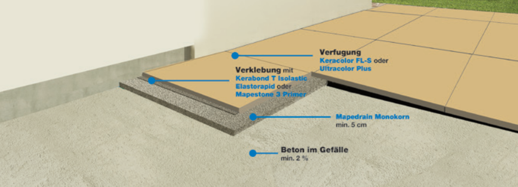
Verlegeempfehlung für Terrassenplatten im Außenbereich in Splittbeton
